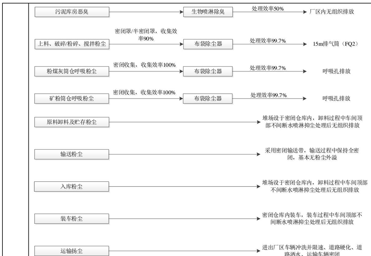
图 4-1 本项目废气收集和治理示意图
