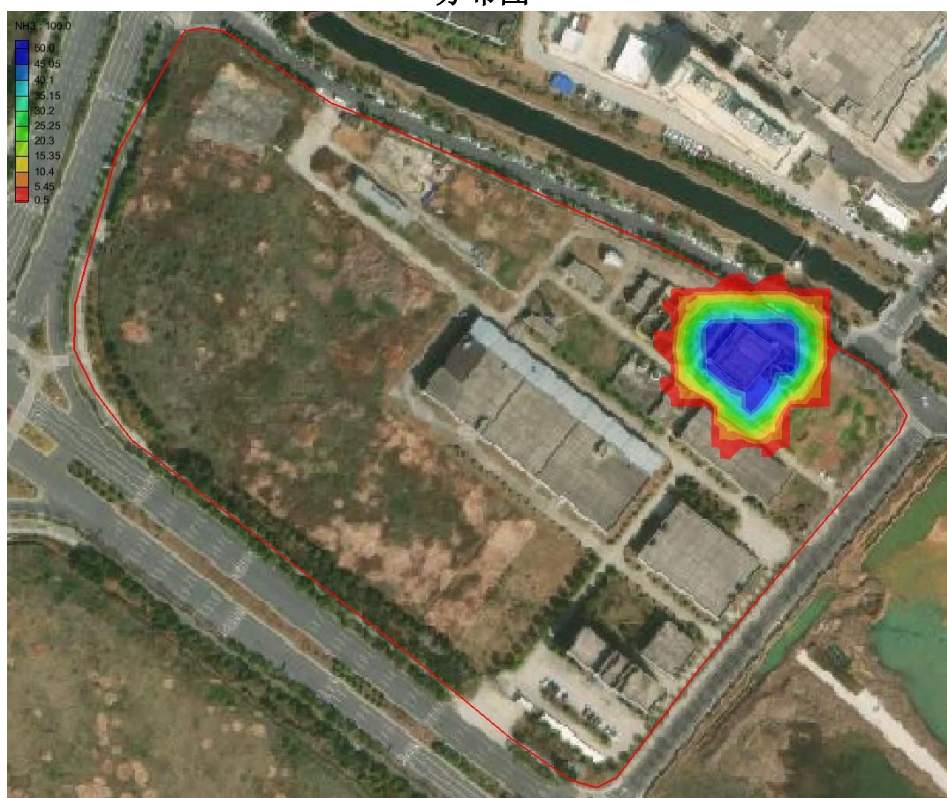
图 6.5-10 非正常工况下综合污水处理站运行 100 天后氨氮运移分布图
