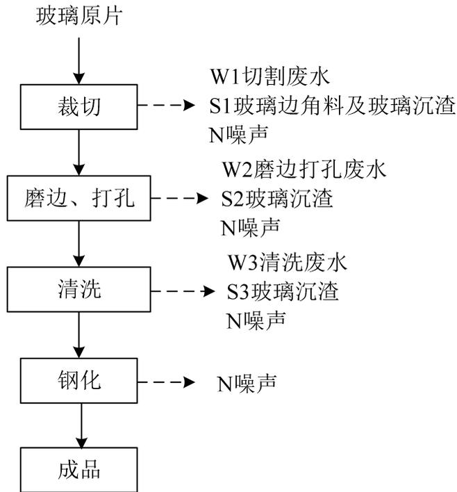
图 2-2 钢化玻璃生产工艺及产污环节图（W—废水、N—噪声、S—固废）
