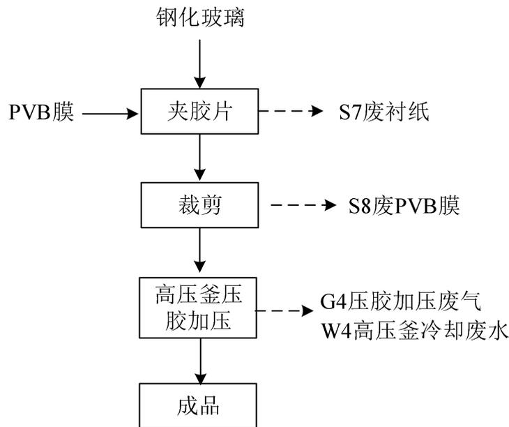
图 2-4 夹胶钢化玻璃生产工艺及产污环节图（G—废气、W—废水、S—固废）
