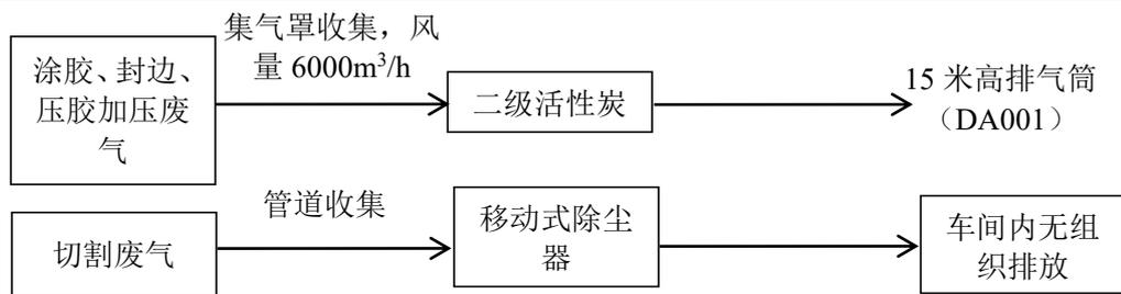
图 4-1 本项目废气治理工艺流程图
