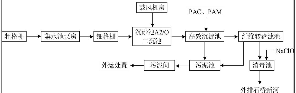
图 4-2 石桥污水处理厂污水处理工艺图
