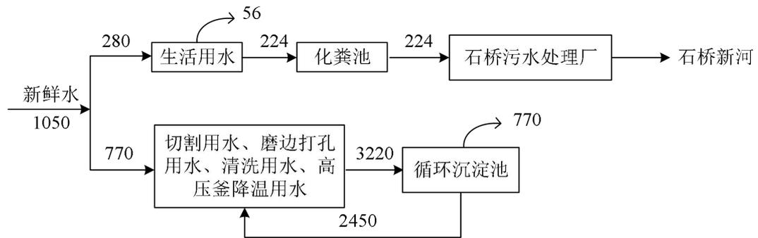
图 2-1 本项目水平衡图（单位：t/a）
