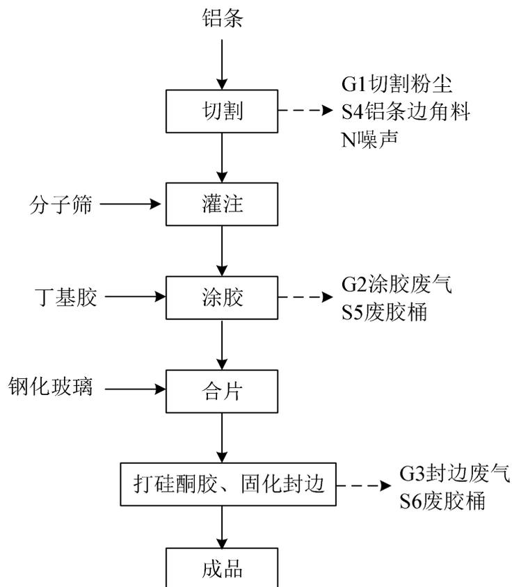
图 2-3 中空钢化玻璃生产工艺及产污环节图（G—废气、S—固废）
